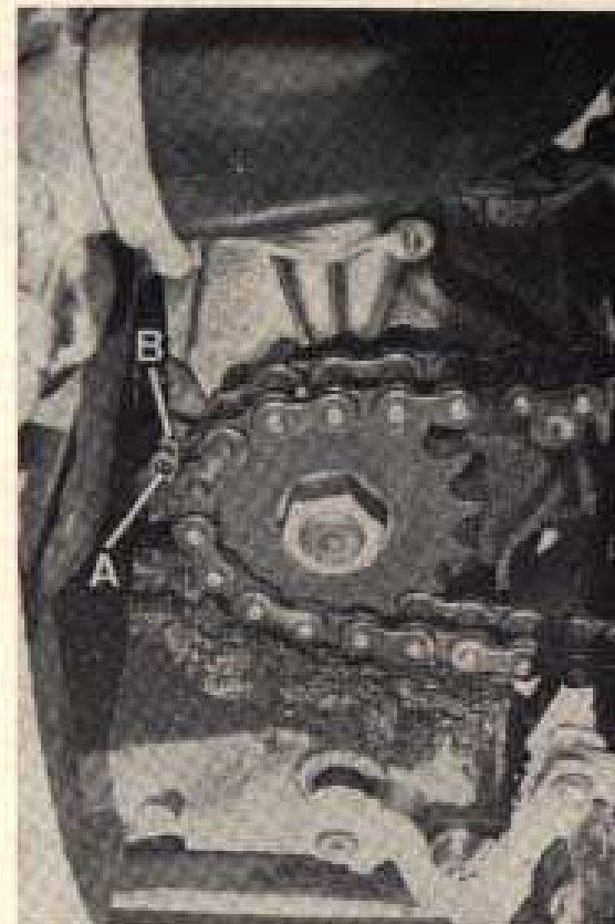
Pour accéder au réglage de la garde du mécanisme d'embrayage, il faut déposer le couvercle arrière gauche du pignon de sortie. A : Vis centrale de réglage - B : Contre-écrou (photo R.M.T.)
