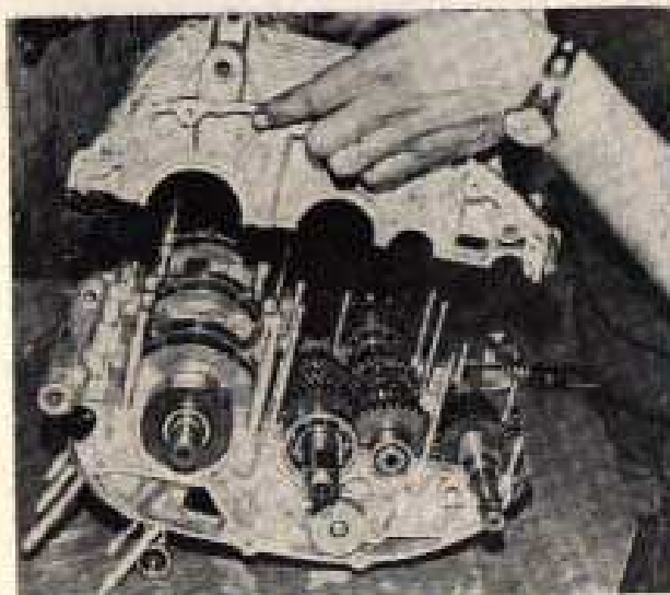
Moteur retourné sur un établi, l'ouverture du carter-moteur découvre l'embellage, la pignonnerie de la boîte de vitesses et le kick-starter (Photo R.M.T.)
