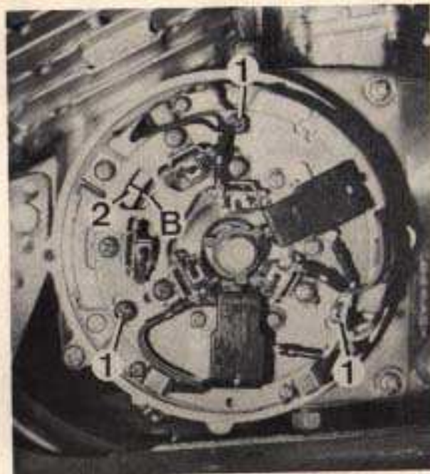
Contrôle de l'avance à l'allumage sur les modèles à deux capteurs (500 H 1 E - H 1 F et KH 500) 1. Les trois vis de fixation du plateau d'allumage 2. Repère fixe - B. Deuxième repère du rotor (Photo RMT)
