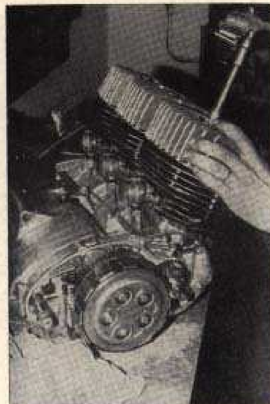
Pour resserrer les culasses, utiliser une clé dynamométrique. Couple de serrage : 2,2 m.kg (Photo R.M.T.)
