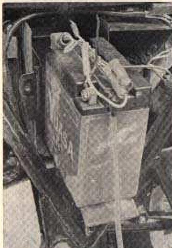
La batterie est facilement accessible après avoir retiré le couvercle gauche et la plaque latérale. Le petit boîtier en plastique renferme deux fusibles dont un de rechange (photo R.M.T.)
