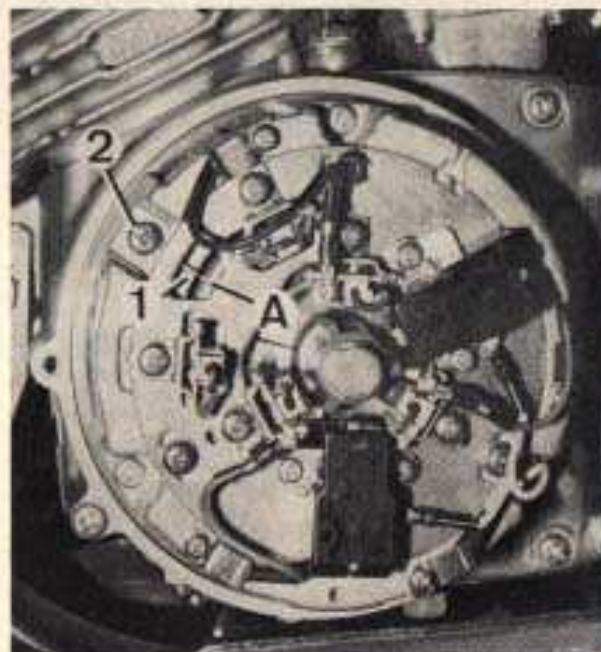
Contrôle du positionnement de l'index fixe avant le calage à l'allumage sur les modèles à deux capteurs (500 H1E - H1F - et KH 500)
